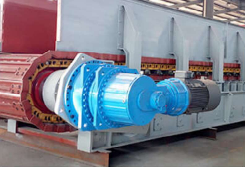
Redüktör, Motor / Drive Device
